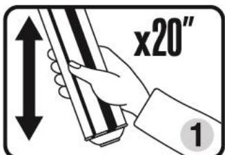
1. Die Oberflächen müssen frei von Staub, Fett, Öl und anderen Verunreinigungen sein. Trockene und poröse Oberflächen müssen mit Wasser befeuchtet werden. Die optimale Verarbeitungstemperatur des Behälters liegt zwischen 20 °C und 25 °C. Wenn die Temperatur niedriger ist, den Behälter ca. 20 Minuten lang in warmes Wasser stellen (max. T=40 °C). Vor dem Gebrauch den Behälter mit nach unten ausgerichtetem Ventil gründlich schütteln (ca. 20 Mal) und den Behälter in die Auspresspistole einsetzen.
