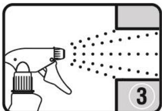
3. Das Befeuchten des aufgetragenen Schaums kann den Aushärtungsprozess beschleunigen. Beim Auswechseln des Behälters den neuen Behälter kräftig schütteln, den leeren Behälter abschrauben und sofort durch den neuen Behälter ersetzen. Der Austausch des Behälters muss schnell erfolgen, um ein Aushärten des Schaums im Adapter zu verhindern. Die ausgehärteten Schaumreste an der Spitze der Verlängerung können nur mechanisch entfernt werden.
