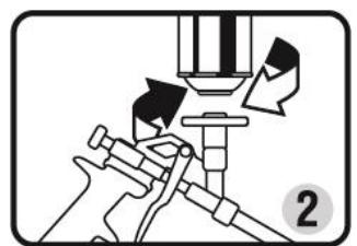
2. Den Abzug betätigen, damit der Schaum hinausströmen kann (ca. 2 Sekunden). Auf diese Weise wird das Verlängerungsrohr mit Schaum gefüllt. Die Pistole ist nun gebrauchsfertig. Während des Auftragens des Schaums die Pistole mit dem Behälter in einer aufrechten Position halten. Der Schaumaustritt kann über den Abzug eingestellt und mit Hilfe der Einstellschraube auf der Rückseite der Pistole kontrolliert werden
