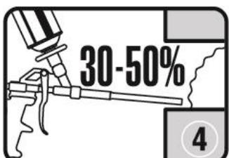
4. Es ist zu beachten, dass sich der Schaum zwischen 30 % und 50 % ausdehnen kann. Wenn ein Hohlraum von mehr als 5 cm gefüllt wird, mehrere Schichten auftragen. Die zweite Schicht auftragen, nachdem die erste ausgehärtet ist. Wenn der Schaumstoff ausgehärtet ist, mit einem scharfen Gegenstand zuschneiden und verputzen, abdecken, streichen usw
