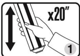
1. Les surfaces doivent être propres, sans graisse, huile ou autres impuretés. Les surfaces sèches et poreuses doivent s'humidifier avec de l'eau. La température optimale de travail est comprise entre 20°C et 25°C. Si la température de la cartouche est plus basse, mettez-la dans de l'eau chaude (max. T=40°C) pendant environ 20 minutes. Agitez énergiquement la cartouche tête en bas (20 fois environ) avant son utilisation.
