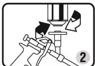
2. Appuyez sur la gâchette et laissez sortir la mousse (environ 2 secondes). Ainsi le tube extenseur se remplit de mousse. Le pistolet est, à présent, prêt à l'emploi. Durant l'application de la mousse, tenir le pistolet en maintenant le produit en position verticale. Le débit de mousse sortant peut être modifié en utilisant la gâchette et vous pouvez le contrôler à l'aide de la vis d'ajustement sur la partie postérieure du pistolet.
