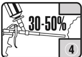
4. N'oubliez pas que la mousse peut s'étendre de 30% à 50%. Si vous opérez sur une cavité de plus de 5 cm, faites le remplissage par couches successives. Appliquez la deuxième couche seulement lorsque la première a séché. Après que la mousse a durci, découpez avec un accessoire aiguisé puis enduire, revêtir, peindre, etc.
