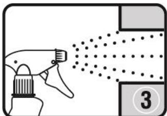
3. Humidifiez la mousse après la pose pour accélérer le temps de durcissement. Lorsque la cartouche utilisée doit être remplacée, agitez la nouvelle cartouche vigoureusement, dévissez la cartouche vide et remplacez-la immédiatement par la nouvelle. Le changement de cartouche doit se faire rapidement afin d'éviter que la mousse ne durcisse dans l'adaptateur. La mousse résiduelle séchée sur la pointe du bariillet ne peut être éliminée que de façon mécanique.
