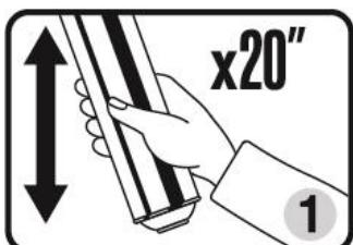
1. Les superficies doivent être propres, sans graisse, huile ou autres impuretés. Les superficies sèches et poreuses doivent s'humidifier avec de l'eau. La température optimale de travail est comprise entre 20°C et 25°C. Si la température de la cartouche est plus basse, mettez-la dans de l'eau chaude (max. T=40°C) pendant environ 20 minutes. Agitez énergiquement la cartouche tête en bas (20 fois environ) avant son utilisation.
