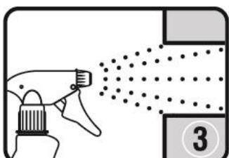
3. Das Befeuchten des aufgetragenen Schaums kann den Aushärtungsprozess beschleunigen.
