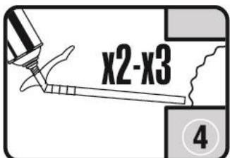
4. Es ist zu beachten, dass sich der Schaum zwischen 2 und mal ausdehnen kann. Wenn ein Hohlraum von mehr als 5 cm gefüllt wird, mehrere Schichten auftragen. Die zweite Schicht auftragen, nachdem die erste ausgehärtet ist. Wenn der Schaumstoff ausgehärtet ist, mit einem scharfen Gegenstand zuschneiden und verputzen, abdecken, streichen usw.
