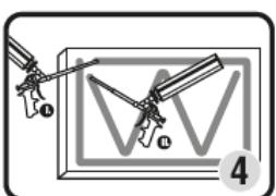
4. Appuyer sur la gâchette et laisser sortir la mousse librement pendant 2 secondes environ. De cette façon, le tube-rallonge se remplit et le pistolet est prêt à l'emploi. Durant l'application maintenir le pistolet muni de la cartouche en position verticale. PU-EP doit d'abord s'appliquer sur les bords puis, sur le reste de la surface de la plaque en dessinant un W. Voir dessin.
