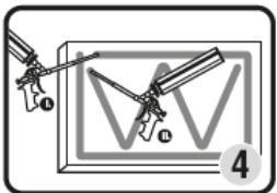
4. Den Abzug betätigen, damit der Schaum hinausströmen kann (ca. 2 Sekunden). Auf diese Weise wird das Verlängerungsrohr mit Schaum gefüllt. Die Pistole ist nun gebrauchsfertig. Während des Auftragens des Schaums die Pistole mit dem Behälter in einer aufrechten Position halten. PU-EP sollte zuerst auf die Kanten und dann in Form des Buchstabens W auf die restliche Oberfläche der Platte aufgetragen werden. Siehe Zeichnung.
