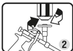
2. Deckel entfernen und Kanüle aufschrauben. Den Behälter nach unten halten und den Schaum durch Betätigung des Ventils auspressen.
