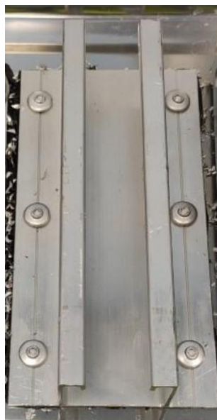
Ejemplo de aplicación 1: montaje de perfil PSA-A
