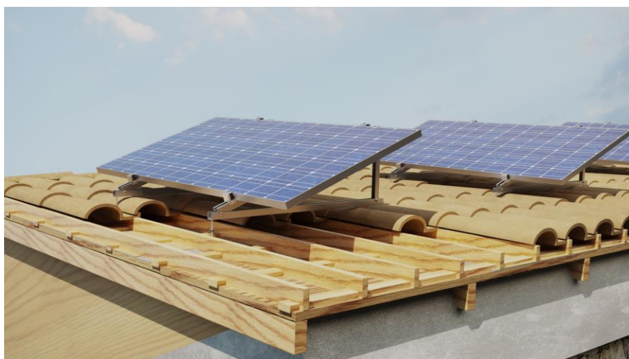
Exemple 2 : Toit en tuiles rondes avec sous-structure en bois/fixation avec boulon à double filetage KFS-MA
