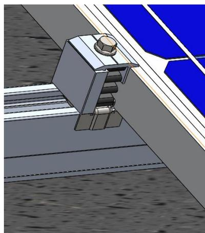
La taille des gabarits choisis doit être égale à la hauteur du cadre des panneaux solaires à installer.
