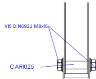
4. Pour le fixer correctement, appliquer un couple de serrage de 15 Nm.
