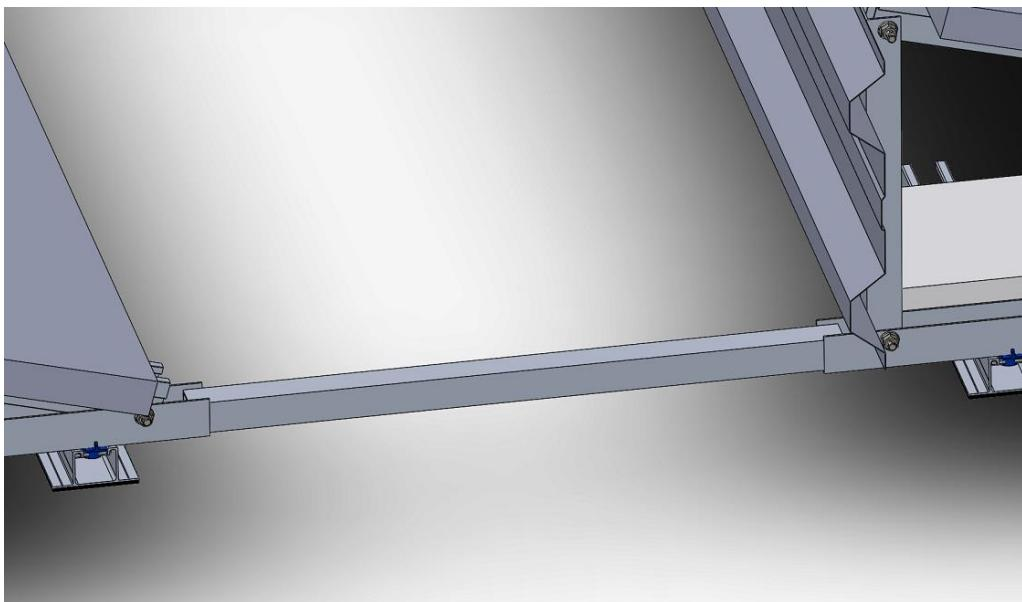
Fixez le profilé de raccordement aux profilés inférieurs à l'aide de deux vis auto-taraudeuses en acier inoxydable de chaque côté. Les vis doivent être installées en croix sur les côtés du profilé, afin qu'elles ne se heurtent pas. Pour l'installation des vis, un tournevis électrique équipé d'une douille hexagonale SW-8 est nécessaire. La vitesse d'installation de 1 800 tours/minute est recommandée.
