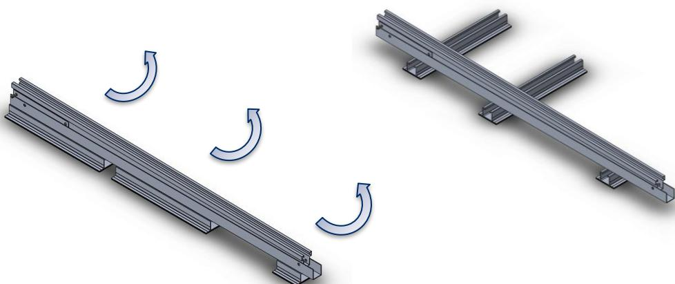
Placez le profilé de support à 90° par rapport au profilé inférieur, insérez la vis inoxydable à travers les deux profilés en plaçant une bague anti-déformation lors du serrage, puis positionnez l'écrou inoxydable à l'autre extrémité et appliquez un couple de serrage de 15 N·m.
