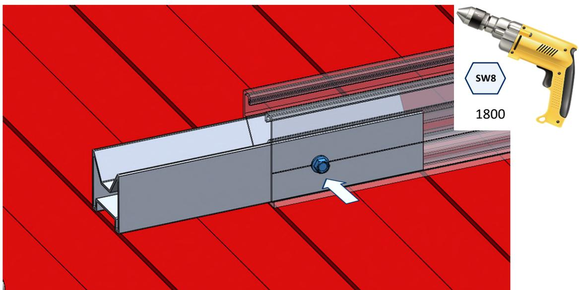
C. Führen Sie das freie Ende des Verbinders PSE-UN in das zweite Profil PSE-A.
