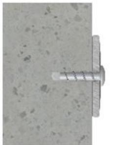
L'ancrage doit être serré après l'installation.
