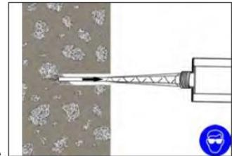
6. Inserte la boquilla mezcladora (tapón de resina/tubo de extensión si corresponde) en el fondo del agujero. Comience a extrudir la resina y retire lentamente la boquilla mezcladora del orificio, asegurándose de que no haya bolsas de aire mientras retira la boquilla. Rellene el orificio hasta aproximadamente entre  $\frac{1}{2}$  y  $\frac{3}{4}$  de su capacidad y retire la boquilla por completo.
