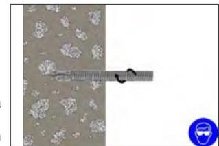
8. Si cualquier exceso de resina saliese del orificio de manera uniforme alrededor del elemento de acero, sería síntoma de que el orificio está lleno. Este exceso de resina debe eliminarse de alrededor de la boca del orificio antes de que fragüe.
