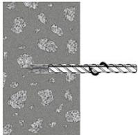
Den Bewehrungsstab frei von Öl oder sonstigen Substanzen mit einer vorwärts und rückwärts ausgeführten Drehbewegung bis zum Bohrlochgrund einführen. Dabei sicherstellen, dass alle Gewindegänge vollständig bedeckt sind. Innerhalb der vorgegebenen Verarbeitungszeit die Position justieren.
