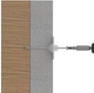
Vissez jusqu'à ce que la rosace affleure sur le matériau isolant.
