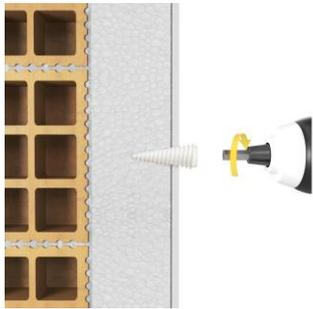
Vissez la vis en plastique dans le matériau isolant.
