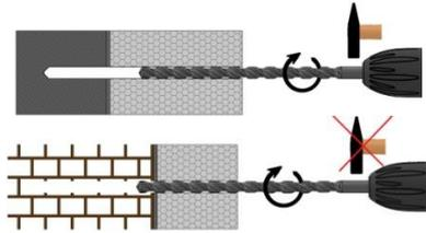
Percez au diamètre et à la profondeur spécifiés dans les tableaux ci-dessus. Perceuse en position percussion ou marteau dans le cas de matériaux solides. Dans le cas de matériaux creux, ne pas utiliser la perceuse en mode percussion, pour ne pas endommager l'intérieur du matériau de base. Réduisez la vitesse de perçage lorsque vous sentez que la sortie du foret se trouve près de l'intérieur creux du matériau de base.
