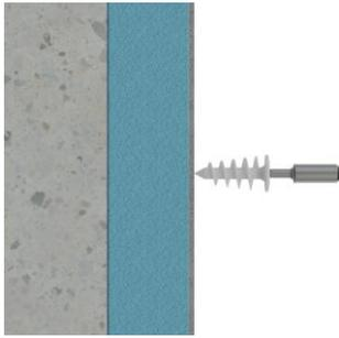
Vissez la tige en spirale au matériau isolant.
