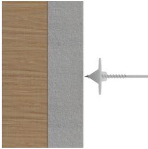
Placez la rosace dans la position souhaitée sur le matériau isolant.
