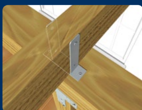
União de pilares para a construção de estruturas
