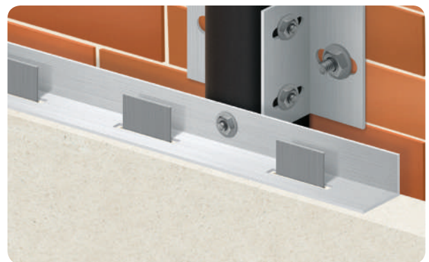
Fixation au moyen de profilés sur le carreau rainuré
