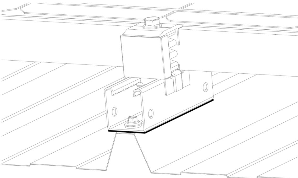
Exemple d'application 2: montage sous guide perforé INDEXTRUT solaire GP-XS
