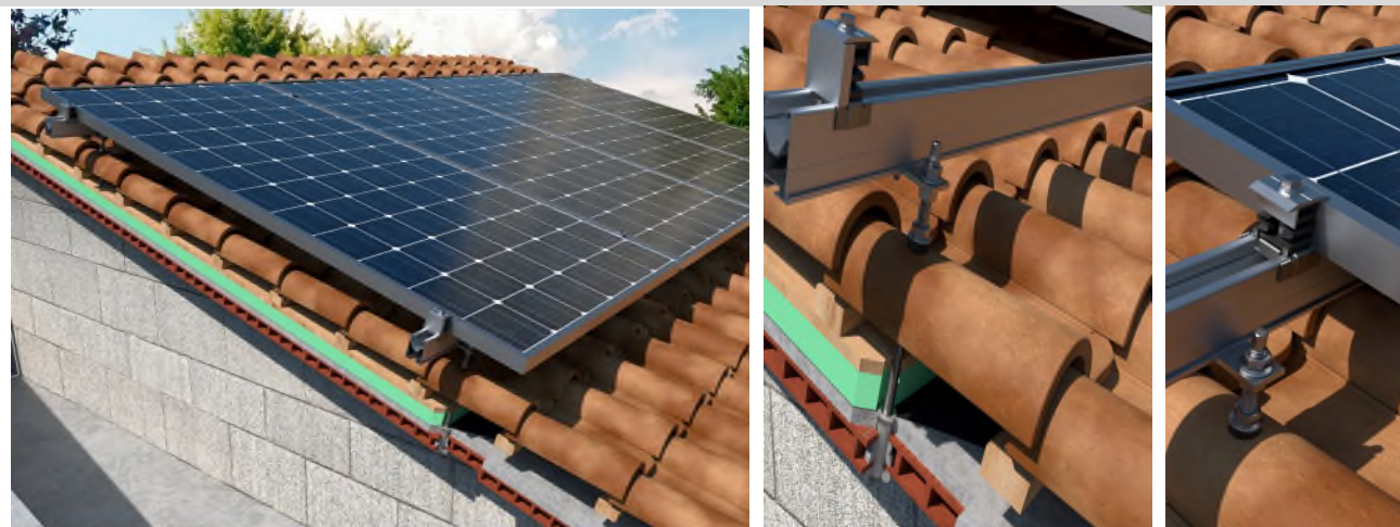
Exemple 2: Toiture de tuiles canal avec sous-structure de maçonnerie / fixation avec crochet pour tuiles GS-TC
