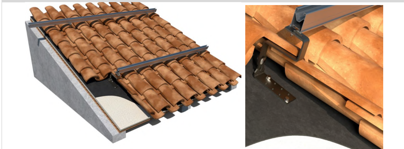
Exemple 2: Toiture de tuiles canal avec sous-structure de maçonnerie / fixation avec crochet pour tuiles GS-TC
