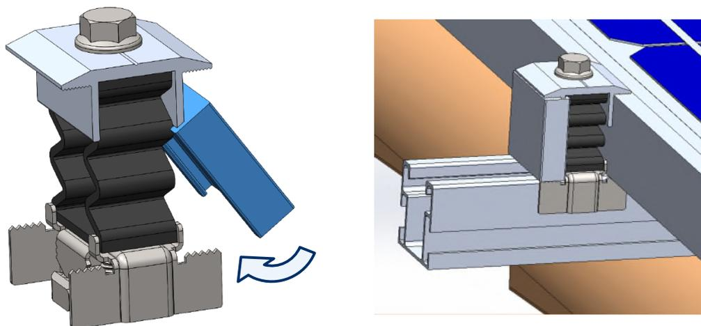
A medida dos espaçadores escolhidos deve ser igual à altura da estrutura dos painéis solares a instalar.
