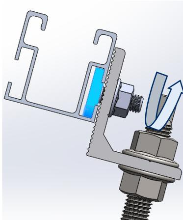
**PASSO 5 - Conexão longitudinal entre perfis**
