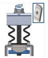
2. Para fijar la grapa al perfil es necesario girar la tuerca inferior hasta la posición perpendicular del perfil mediante el tornillo, se presiona la cabeza del tornillo y se gira. La tuerca cuenta con un raíl dentado para asegurar la fijación.
