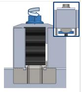
4. Para fijar los elementos introducidos es necesario girar el tornillo hasta que entren en contacto con el perfil. Comprobar que la tuerca inferior sigue perpendicular al perfil.
