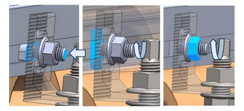
**D.** Debe comprobarse que la cabeza del conector KFS-FI queda orientada en sentido perpendicular a la ranura del perfil PSE-C, y que el cuello cuadrado del conector queda encajado correctamente en el borde de la ranura.
