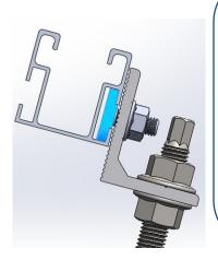
Para asegurarse de que la cabeza del conector KFS-FI queda orientada en sentido perpendicular al perfil existe una muesca en la base del tornillo. Esta muesca indica la posición final de la cabeza, por lo que es necesario que cuando acabe la instalación se encuentre perpendicular al perfil. Nunca debe quedar la muesca paralela al perfil o inclinada una vez apretado.
