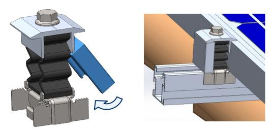
La medida de galgas elegidas debe ser igual a la altura de marco de las placas solares a instalar.
